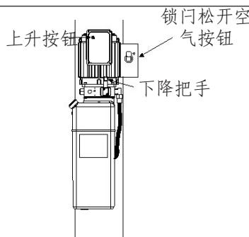
10. 给电机立柱上的锁闩松开阀通电，解除所有四个锁闩，见图2。按住执行器按钮，直到举升机完全降下。。
