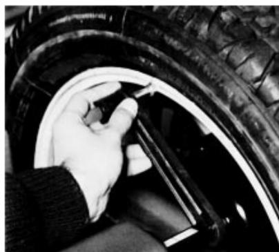
重新输入正确的轮圈尺寸然后按 OK 键。这时可以开始平衡。
