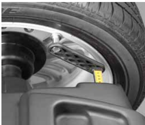
图 24a 内侧测量尺顶在钢圈内沿平面
