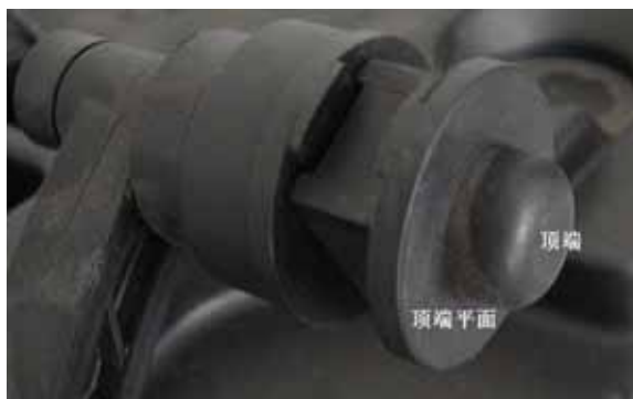
图 23 内侧测量尺端头
