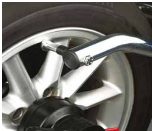
图 24b 外侧测量尺顶在钢圈外沿平面
